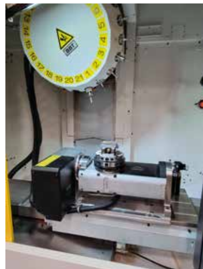
Et kig ind i vores fem-aksede Fanuc-maskine, hvor tilt og twist ligger i bordet.
