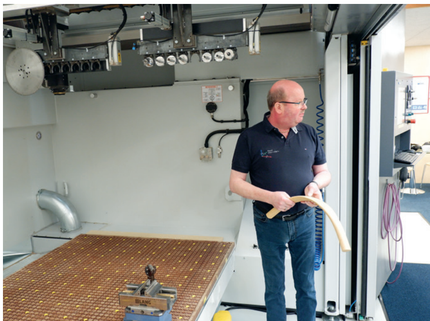
En af de seneste investeringer er den fem-aksede CMS Ares 4818, som indgår i undervisningen på kursusforløb i »3D overflader og 5-akset bearbejdning« samt anvendes til demofræsning.
