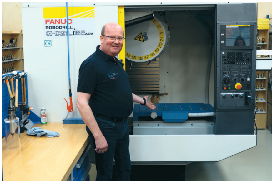
Den tre-aksede Fanuc Robodrill CNC-maskine bliver hyppigt anvendt i undervisningen. Maskinen er let at betjene, og man kan se bearbejdning af emnerne tæt på gennem maskinens låge.
