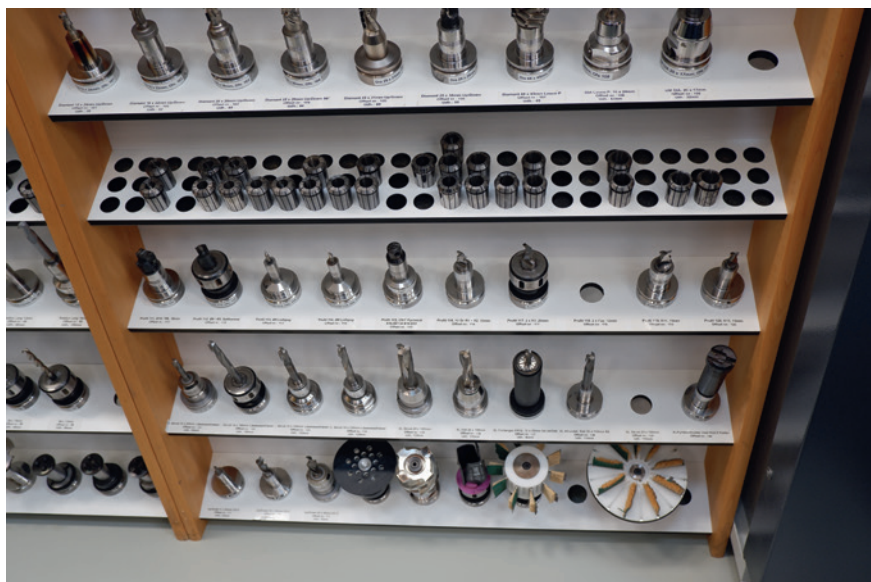
Østjydsk CAD-CAM råder over mange værktøjer til CNC-maskinerne, hvor alle er monteret i egen holder, opmålt, og data ligger på styringen. Det betyder en stærkt reduceret op- og omstillingstid på maskinen og dermed bedre indtjening.
