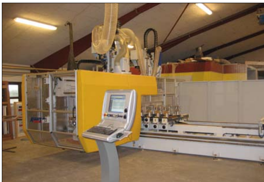
Virksomheden kan nu producere vinduer fra omkring 20 cm i bredden og op til flere meter på samme maskine.
