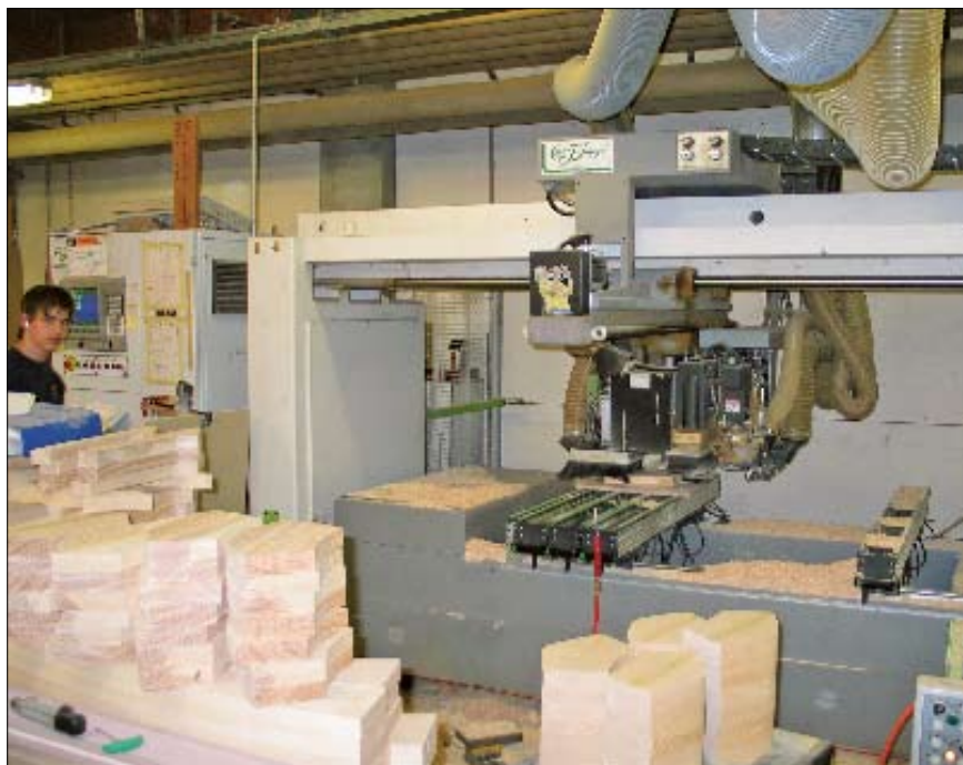
Snedkeriet implementerede først AlphaCAM på deres tre-aksede maskine, og senere blev softwaren opgraderet til brug på den nye fem-aksede maskine.
